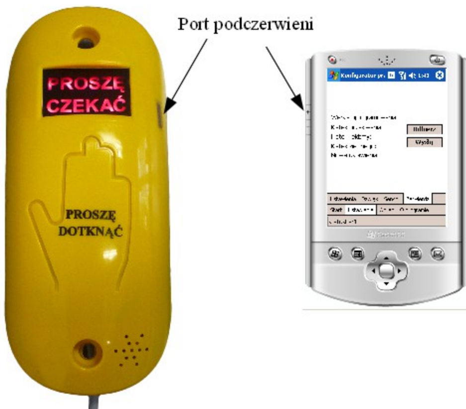
Ilustracja 16: Sposób komunikacji przycisku i Pocket PC
